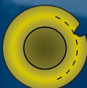
La cabeza del remache no debe tener fisuras ya que disminuyen su resistencia.
