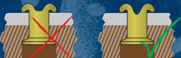
4. En remaches semi-tubulares, la punta debe ser suficientemente profunda para evitar que el punzón "tope" (encuentre resistencia) teniendo como resultado un remachado deficiente.
