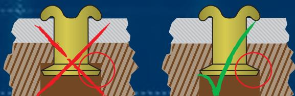
Por sus propiedades mecánicas y resistencia a la dilatación térmica, los remaches deben ser de latón o acero tropicalizado. Preferentemente utilice remaches tubulares.
